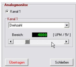
Im Menü **OPTIMIERUNG / ANALOGMONITOR** kann dem Analogausgang einer der folgenden Größen zugeordnet und skaliert werden:
