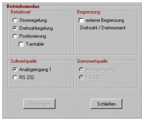
Im Betrieb ohne Feldbus (**I/O-Betrieb**) können Betriebsart und Sollwertquellen unter **OPTIMIERUNG / BETRIEBSMODUS** eingestellt werden.
