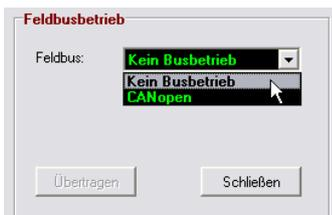
Der Servoverstärker DSV11x ist sowohl über digital / analoge Ein- und Ausgänge (**I/O- Betrieb**) als auch über CANopen (**CANopen Betrieb**) zu bedienen. Die Aktivierung / Deaktivierung der CANopen Schnittstelle sowie die Vorgabe von Node-ID und Baude Rate erfolgt über das DSerV- Menü **OPTIMIERUNG / FELDBUSBETRIEB**.
