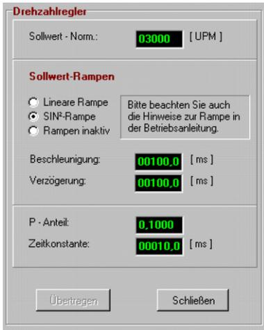
Im Menü **OPTIMIERUNG / DREHZAHLREGLER** werden die Parameter des Drehzahlregelkreises eingestellt:
